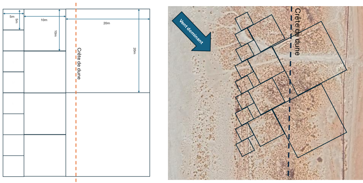
Figure 17 : à gauche : Schéma de principe de clayonnage dégressif / à droite : positionnement proposé dans le cas de Nouakchott (source : setec international / Dr Dia)
